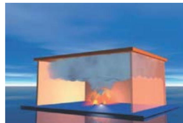
A füst hamar szétterjed oldalirányba is a tető alatt, távolodva a tűzfészekről.
