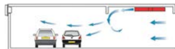
COLT Jestream terelő ventilátoros rendszer hátránya
