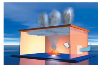
Hő- és füstelvezető, frisslevegő utánpótló termékekkel ellátott épület.
